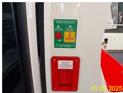
รูปที่ 2-16 ปุ่มกดฉุกเฉินบนขบวนรถไฟฟ้า
